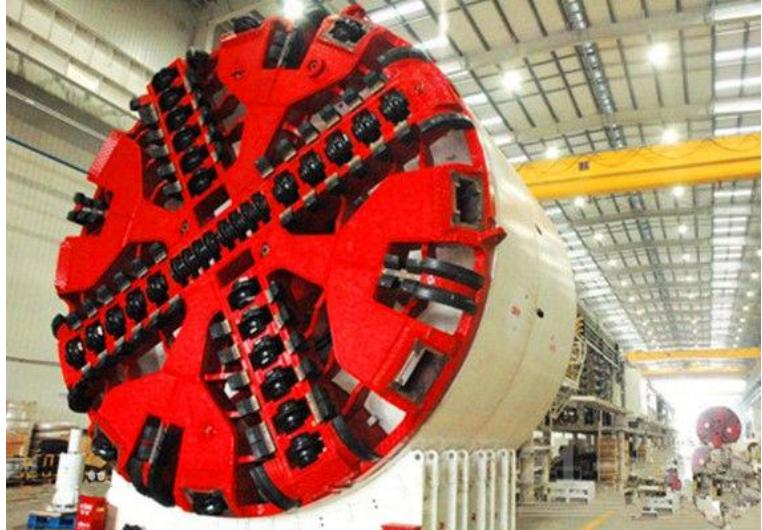
A large red and white土压平衡盾构机刀盘，展示了其复杂的刀具和支撑结构。背景是一个工业车间。 |
